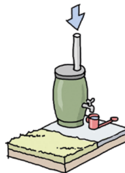
Abb. 8.4 Auffangen des Regenwassers in einer Regenrinne zur Gartenbewässerung
